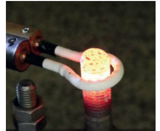
▶ Erwärmen eines Gewindebolzens mit der wassergekühlten Spule
