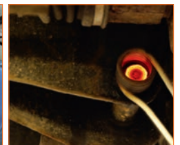
▶ Erwärmen und Lösen von festsitzenden und angerosteten Teilen
