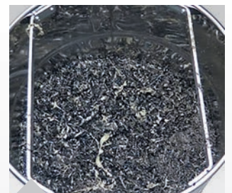
Edelstahlbehälter ist unempfindlich gegenüber scharfkantigen Metallspänen
