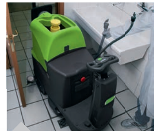
Frischwassertank mit Schlauch für Schnellbefüllung
