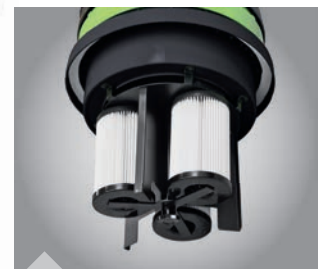
3-Filterreinigung Dank des automatischen Zyklus werden alle Filter gereinigt, während der Sauger ununterbrochen weiterarbeitet, ohne an Saugleistung zu verlieren. (dryCAT 362 IRSC-3)
