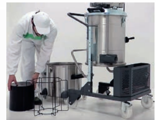
Aluguss Sauganschluss Ø 50 mm mit Schnellverschluss
